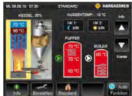
**Kessel im Teillastbetrieb:** Der Kessel läuft nur mehr mit kleinster Leistung. Der Boiler und der Puffer sind durchgeladen. Die Heizkreise liefern Wärme in die einzelnen Wohnbereiche.
