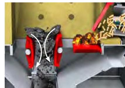
Bei kaltem Kessel erfolgt vor dem Neustart eine komplette Brennhammerreinigung. **Beide Roste öffnen**, kalte Asche und Schlacke werden entsorgt. Durch die zusätzliche „**Brecherfunktion**“ des Drehrostes wird die Schlacke gebrochen. Der Fixrost bleibt geschlossen.
