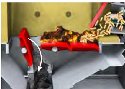
Beim Einsatz von Pellets als Brennmaterial wird bei der Entaschung nur der **hintere Drehrost** geöffnet. Die Asche fällt runter, die Restglut bleibt bestehen.
