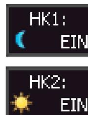
Die **3G Tag/Nacht-Absenklogik** ermöglicht es dem Kunden, 3 Außentemperaturgrenzwerte zu bestimmen. Es gibt einen Wert für „Heizen am Tag“, einen für „Absenken am Tag“ und einen für „Absenken in der Nacht“. Somit läuft die Heizung nur dann, wenn es wirklich nötig ist. Das spart Energie ohne Komforteinbuße.
