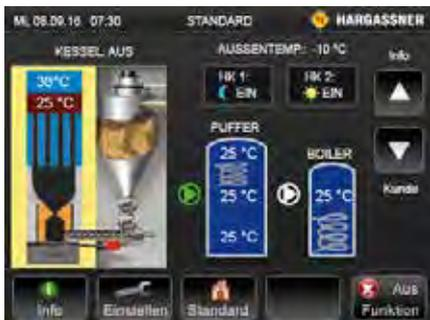
**Kessel vor der Inbetriebnahme:** Das Display der Lambda Touchtronic zeigt Ihnen einen nicht beheizten Kessel. Der Boiler und der Puffer sind kalt bzw. nicht geladen.
