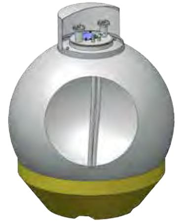
Eine weitere, bereits fertige Lagerraumlösung stellen die kugelförmigen Erdtanks aus korrosionsfestem, glasfaserverstärktem Polyesterharz GFK dar. Nahtlos und fugenlos im patentierten Kreuzwickelverfahren gefertigt, ist keine Verstärkungen aus Stahl oder Beton notwendig. Höchste Betriebssicherheit ist gewährleistet durch ein spezielles Sicherheitspaket mit vollem Ex-Schutz für den Behälter.
