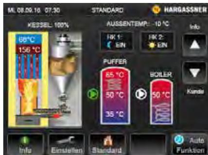
**Kessel im Vollastbetrieb:** Das Display zeigt Ihnen einen beheizten Kessel. Der Boiler und der Puffer werden bereits geladen und sind schon warm. Die Heizkreise liefern Wärme in die einzelnen Wohnbereiche.
